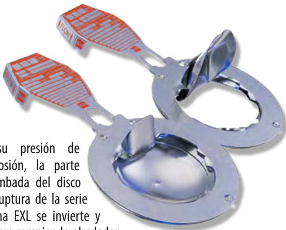
A su presión de explosión, la parte abombada del disco de ruptura de la serie Sigma EXL se invierte y se abre rompiendo alrededor una hendidura de corte circular ubicada cerca del perímetro del domo. La hendidura de corte se vincula con uno o más puntos en la bisagra integrada aguas abajo del disco. El disco se abre mientras la parte o pétalo central se sostiene por la bisagra, evitando así su fragmentación. El disco Sigma EXL se ofrece con una tolerancia simple a la presión de explosión.
